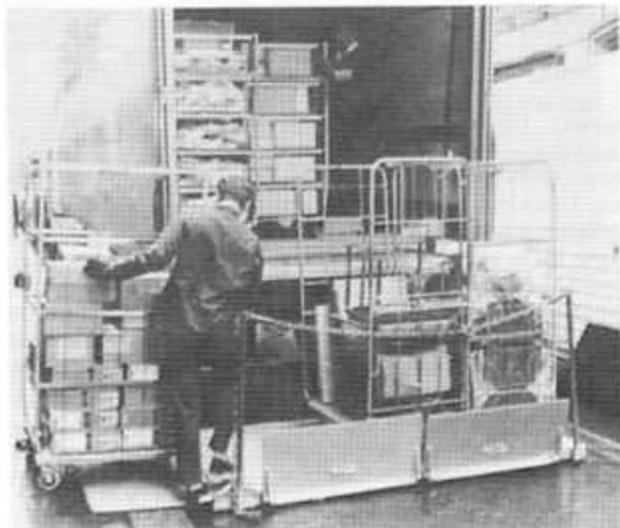
Fig. 10. — Hayon sur glissières. Opération de déchargement.
